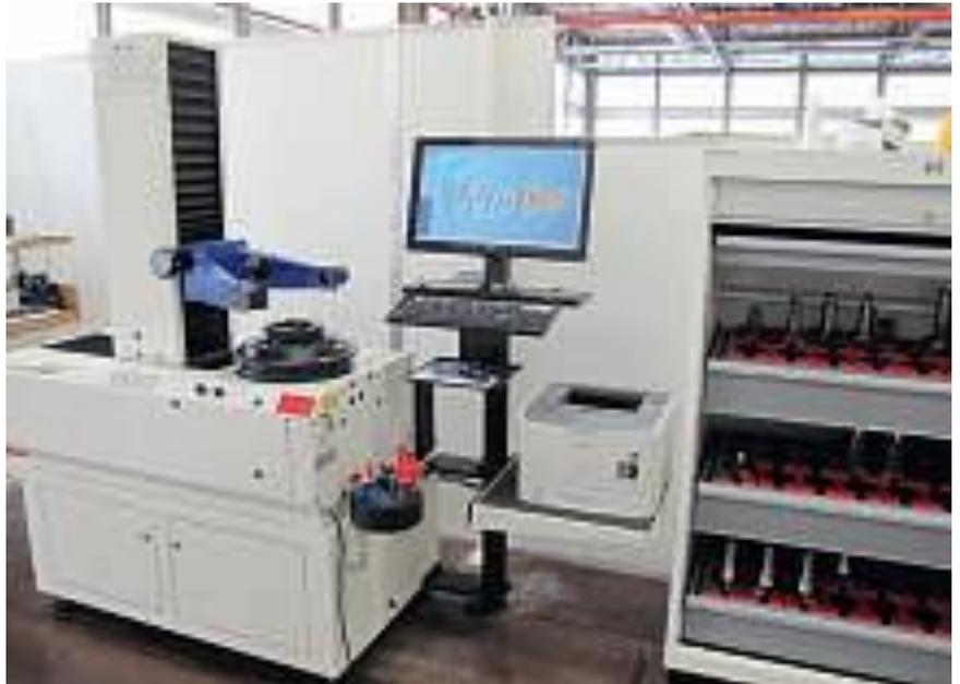
Auf dem Werkzeugvoreinstellgerät mit PC ist WinTool installiert; der Werkzeugsinsteller kann zwischen Voreinstellgerät und Software umschalten.
